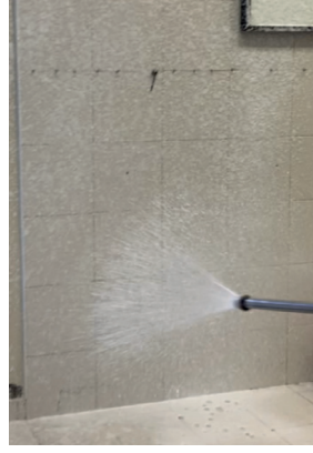
Görsel 1. Dik Yüzeyde Köpük Performansı Testi
