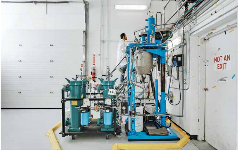
Sublime Systems'in pilot tesisi, her yıl 50 beton kamyonunu doldurmaya yetecek kadar çimento üretmek için elektrokimyayı kullanıyor.
