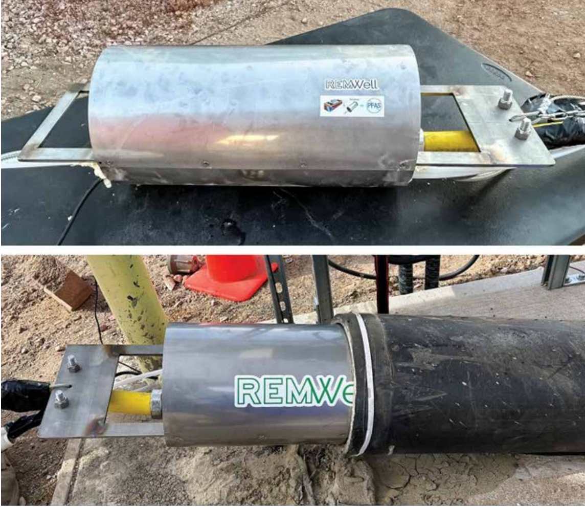
RemWell, yeraltı suyundaki per- ve polifloroalkil maddeleri parçalamak için ses dalgalarını kullanan bir yeraltı teknolojisini ticarileştiriyor.
